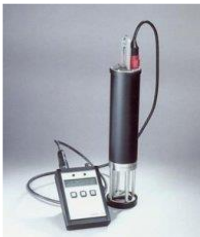
Rysunek 6. Profilomierz prędkości dźwięku w wodzie Reson SVP 15
