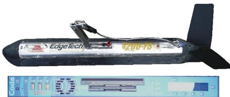
Rysunek 8. Holowany sonar boczny EdgeTech 4200 oraz system akwizycji danych Coda GeoSurvey DA 1000
